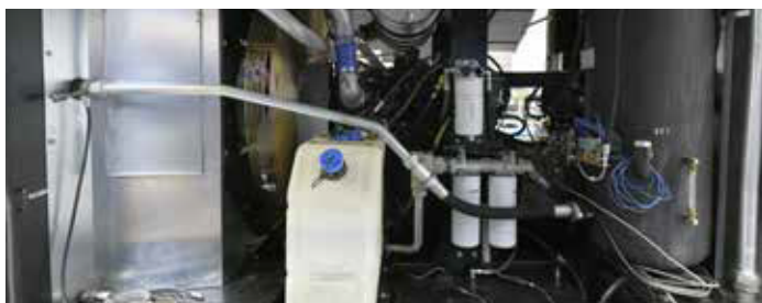
Posizione centralizzata dei componenti per una manutenzione ordinaria più rapida
