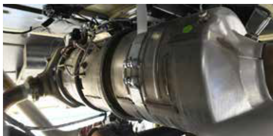
Manutenzione semplificata con un contenitore singolo di post-trattamento
