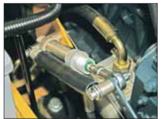
Quando si arresta il pompaggio il deceleratore rallenta automaticamente il motore. Riducendo carburante e rumore.
