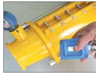
La CLB 18 è dotata di una pulsantiera con cavo elettrico per il comando a distanza. A richiesta un comodo radiocomando.
