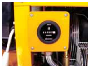
Il contatore aiuta a programmare il lavoro e la manutenzione.
